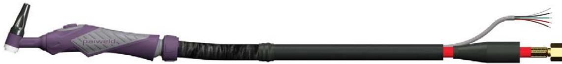
Las antorchas se suministran como estándar en una longitud de 12Ft ( 3,75 mt aprox.) y 25 Ft ( 7,70 mt), con tapa, micro-interruptor ON/OFF, cable de señal de 5 polos sin conector de maniobra. La terminación del cable de potencia termina es de tuerca hembra 3/8" y, se suministra sin los consumibles.
